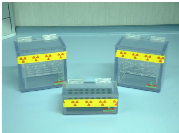
Cajas de pvc transparente para transporte y almacenamiento de material radiactivo marcado con radioisótopos  $\beta^-$
